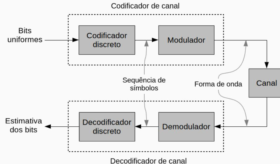
O **codificador discreto** realiza **controle de erros**: Adiciona redundância controlada.
