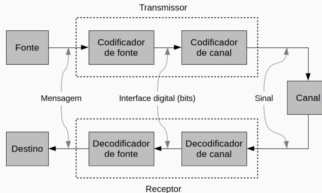
*Observação:* A interface digital é tipicamente (mas não necessariamente) *binária (0s e 1s)*.
